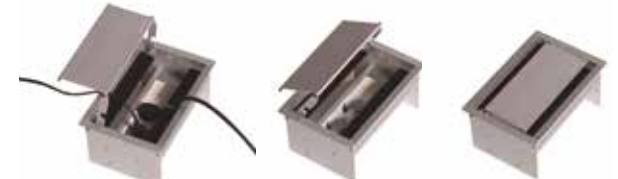
PRZ 03 / W 207mm / D 137 mm / H 100 mm. Priz Kutusu / Outlet Box Şebeke Prizi / UPS Prizi Cat 3 Telefon Konnektörü Cat 6 Data Konnektörü
